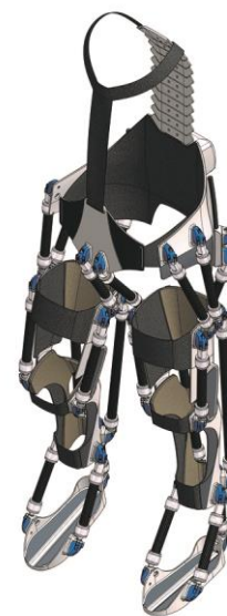
Exoskelett für die unteren Extremitäten, angetrieben durch pneumatische Muskeln
