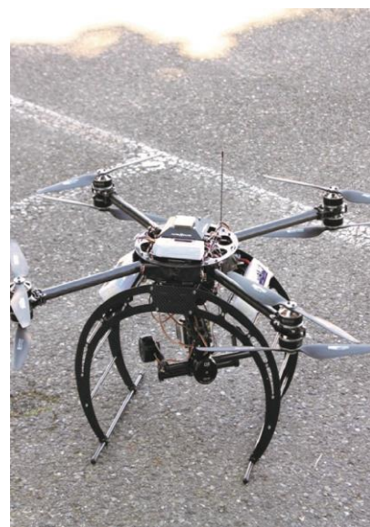
Der fliegende Versuchsträger X8 in seiner aktuellen Konfiguration mit kardanischer Kameraaufhängung
