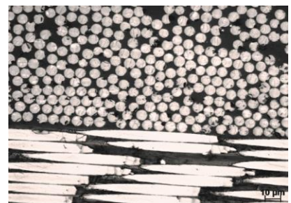
Zum Vergleich ein Schriffbild mit Epoxid-harzmatrix, wie dies gewünscht wäre. (Auflösung 500x)
