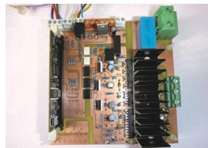
Die zur Ansteuerung des IPMs entwickelte Wechselrichterhardware mit Mikrocontroller.
