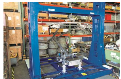
Der neuentwickelte Pantoprüfstand der Firma PROSE AG. Am Querbalken ist der Linearmotor befestigt.
