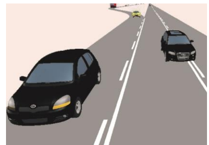
Ausschnitt aus der Simulationssoftware VISSIM. Die Fahrzeuge wechseln die Fahrstreifen kooperativ.
