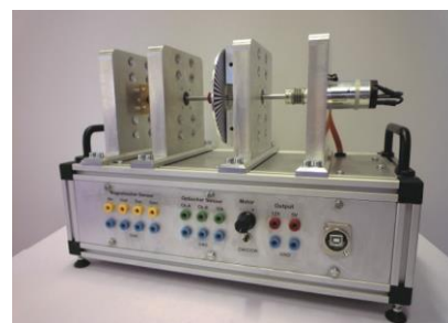
Prototyp des Drehgeber Messplatzes mit dem optischen und magnetischen Encoder.
