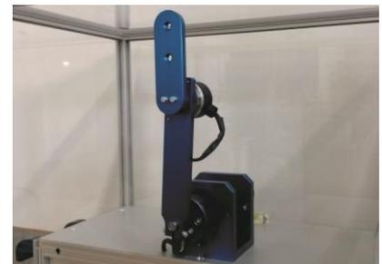
Das invertierte Doppelpendel-Modell "Pendubot" wird mit Hilfe einer B&R-SPS in die 12-Uhr-Stellung geregelt
