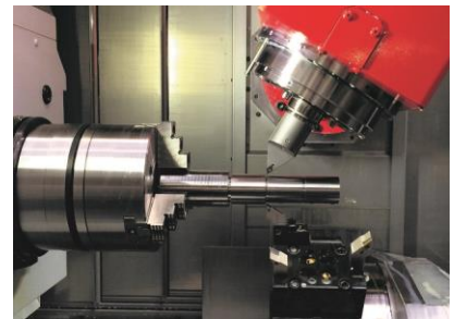
Synchrondrehen: Gleichzeitiges Bearbeiten mit der Spindel und dem Revolver
