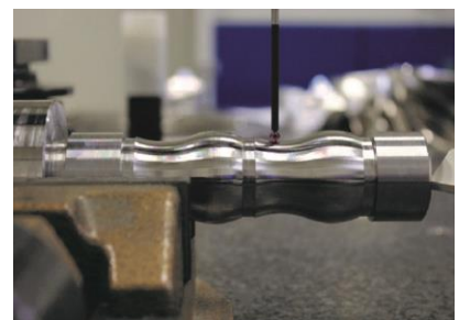
Konturmessung eines Probenwerkstückes des Versuches 4
