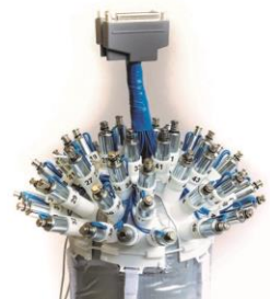
Abbildung des Therapie-Tools mit 48 einzeln angesteuerten Solenoiden. Das Therapie-Tool wird mit zwei D-Sub Kabeln mit der Steuerung verbunden.
