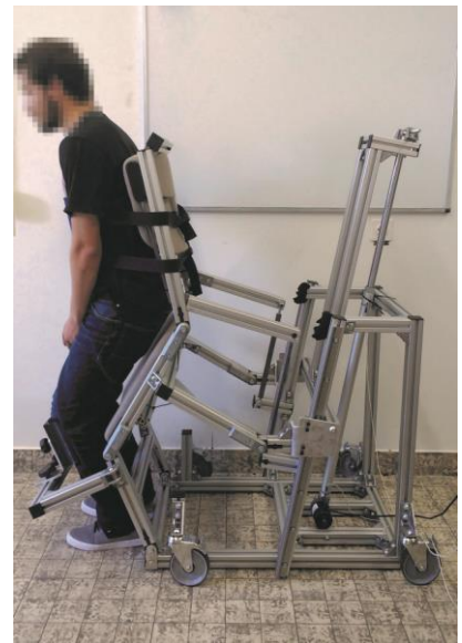
Der Benutzer vollführt die Aufstehbewegung, wobei der Aktuator die Sitzflächen und Rückenlehnenbewegung steuert.
