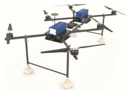
Hexacopter mit 15"-Propellern und Pixhawk-Board
