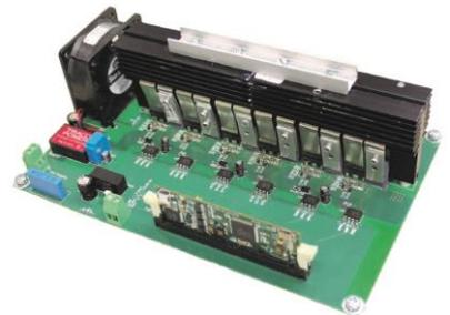
SiC-Drehstrombrücke bestehend aus der Kaskoden-Schaltung eines SiC-JFET und eines Si-MOSFET
