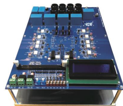
Multilevel-Umrichter für eine Zwischenkreisspannung von 750 VDC und eine Ausgangsleistung von 6 kW
