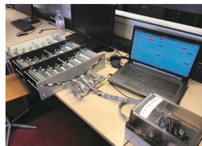
Systemübersicht: Mock-up, Roboter, User Interface und Steuerung
