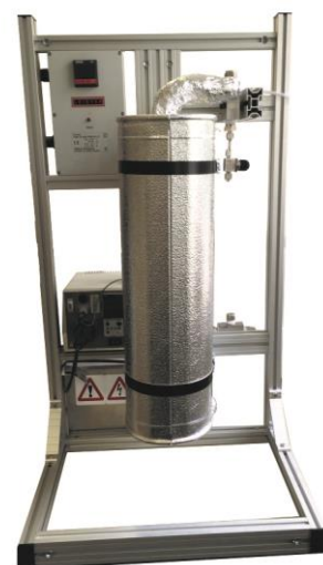
Auf der Abbildung ist die aufgebaute Demonstrationsanlage ersichtlich, welche während der Bachelorarbeit aufgebaut wurde. Dazu gehören der zentral liegende Reaktor mit der Isolationsbox sowie die an der Halterung angebrachten Peripherie-Geräte, welche für die Methanisierung benötigt werden.
