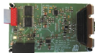
Der entwickelte 24-Bit-Strom-Messprint misst den zu regelnden Strom von \pm 5 A mit einer Genauigkeit von \pm 120 ppm.
