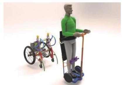
Das SSF-System mit abgekoppeltem Segway für die stehende Fortbewegung.
