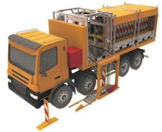
Gesamtansicht der Leitbaken- Setzmaschine auf einem Wechseladerfahrzeug
