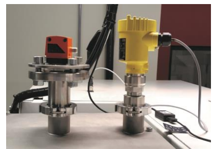
Sensoren für die Füllstandmessung (rechts; alter Sensor / links; neuer Sensor)
