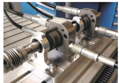
Aufbau der hydrostatischen Gleitlager auf einem Prüfstand
