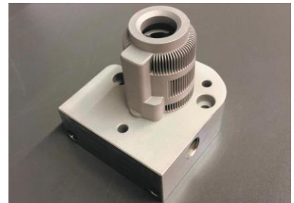
Hergestelltes hydrostatisches Gleitlager mittels SLM-Hybrid- Bauteilen
