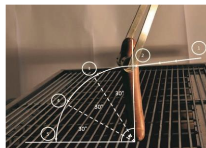
Die Abbildung zeigt die Bahn, die der Greifer durchläuft, nachdem er die Wurst gegriffen und angehoben hat. Wenn der Greifer Punkt 2 erreicht, liegt das untere Wurstende auf der Grillfläche auf. Danach wird sie in einem Kreisbogen abgelegt.
