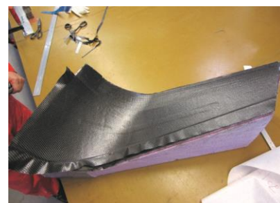
Im Bauprozess: untere Halbschale
