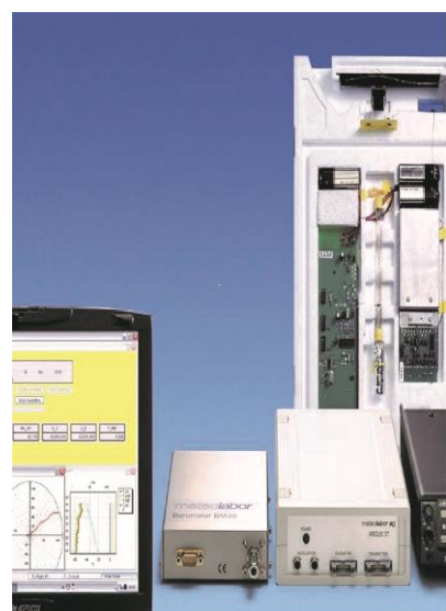
Ballonsondierungssystem Argus 37 Hardware-Komponenten mit der geöffneten Sonde im Hintergrund und den Komponenten der Empfangsstation im Vordergrund
