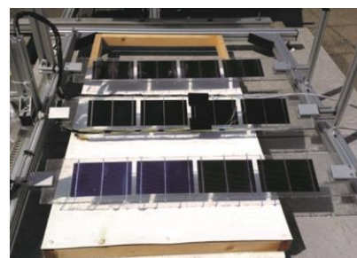
Mini BPRP zur Vergleichsmessung zum BIFOROT, um Konfigurationsänderungen schnell durchführen zu können.
