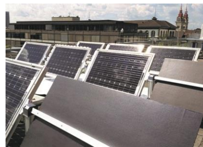
BIFOROT-Teststand zur Messung des Ertrages von bifazialen Solarmodulen als Funktion des Neigungswinkels
