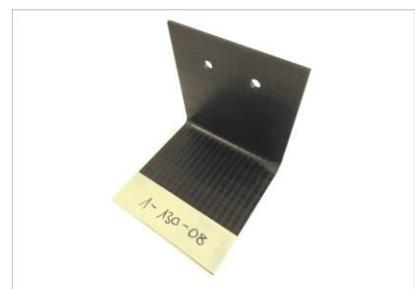
Carbon-Prüfstück für Komponententprüfung eines Holm-Schalenübergangs
