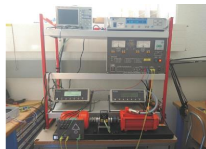
Testaufbau mit Asynchronmaschine und Bremsmotor
