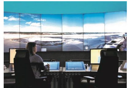
Im Remote-Tower-Center werden die übertragenen Bilder auf mehreren Bildschirmen dargestellt. Der Lotse erhält auf diesen Bildschirmen ausserdem zusätzliche visuelle Hilfen.
