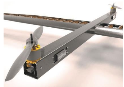
Konzept des Motorträgers mit integriertem Schwenkmechanismus
