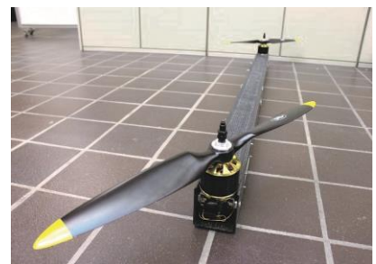
Proof of Concept eines Motorträgers
