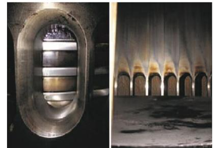
Der Zugang zur zylindrischen Laufbuchse ist erschwert. Wenn sich der Kolben am unteren Totpunkt befindet, kann die Messvorrichtung durch die Lüftungsschlitze montiert werden.
