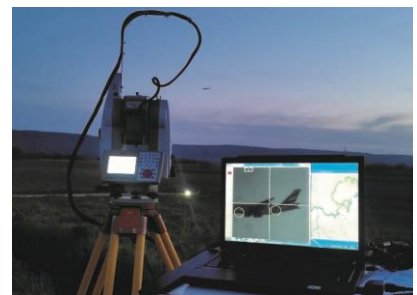
Das Bild zeigt das Messsystems QDaedalus. Es sind der optische Tracker, die Diode für die Kamerakalibration, sowie der Laptop zur Verarbeitung der Daten abgebildet. Im Hintergrund und auf dem Bildschirm ist das zu vermessende Flugzeug erkennbar.
