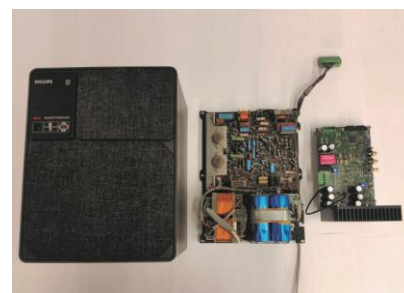
Originale Lautsprecherbox von Philips mit analoger Platine. Dazu als Vergleich ein Aufbau mit \mu Controller, auf den der Regler portiert wurde.
