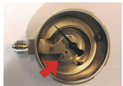
Die Dimensionen sind eine grosse Herausforderung. Die Anlage muss in der Lage sein, den Bügel zu lokalisieren und präzise umzuformen. Das Gehäuse des Manometers hat einen Aussendurchmesser von 63 mm.
