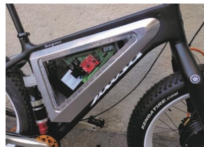
Zusammenbau von Gehäuse mit Akku und gefertigter Elektronik
