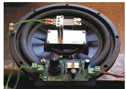
Piezoelektrischer Harvester auf Harvesting System mit der dazugehörigen SSHI-Schaltung
