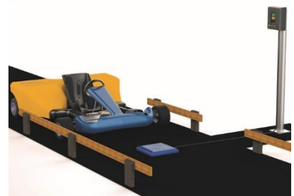
Produkt-Szenario für den Einsatz der WPT-Schaltung beim Elektrokart
