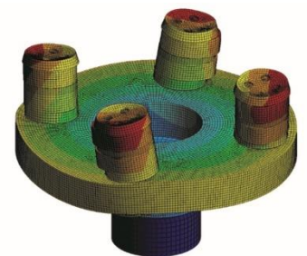
Ansys-Deformationsbild der neuentwickelten unteren Getriebestufe
