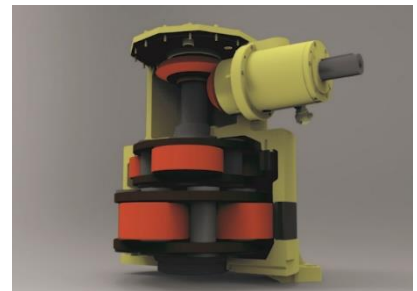
Aufgeschnittenes Seilbahngetriebe SKP-14 mit zwei Planetenstufen und einer Kegelradstufe
