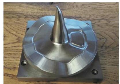
Additiv gefertigte Spritzgussform mit konturnahen Temperierkanälen
