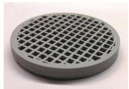
Dieser Keramik-Rundfilter mit einem Durchmesser von 25 mm wurde mit einer Layerhöhe von 0.3 mm gedruckt.
