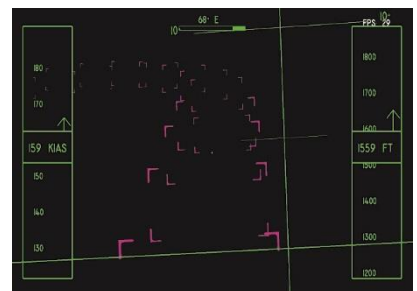
Endgültiges Anzeigeformat mit Flugtunnel, angezeigter Fluggeschwindigkeit, Höhenanzeige, Steuerkurs und Fluglage.
