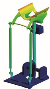
Verformung der Mechanik gemäss FEM bei 9 g und voller Turbinenleistung (25-fach verstärkte Darstellung).
