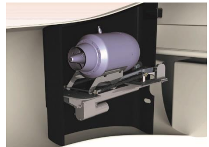
CAD-Modell der eingefahrenen Turbine im Rumpf.
