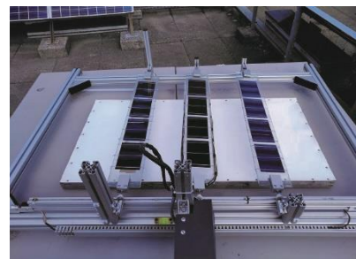
BPRP-Messstand mit reflektierender Unterlagsfolie bei einem Modulanstellwinkel von 0°.
