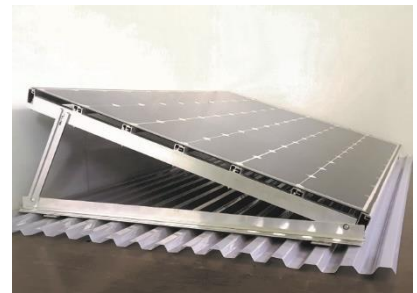
Der selbstaufgebaute Demonstrator besteht aus einem Leichtbau-PV-Modul mit einem 0.8 mm Glas/Glas-Aufbau, einem rückseitigen Rost aus Aluminiumprofilen als Verstärkung und einer Aufständering mit verstellbarem Winkel.
