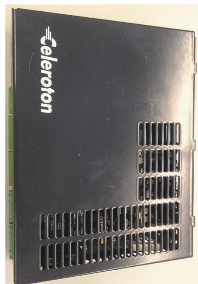
Modul, welches zwischen Umrichter und Motor angeschlossen wird und die Position des Rotors sensorlos bestimmt
