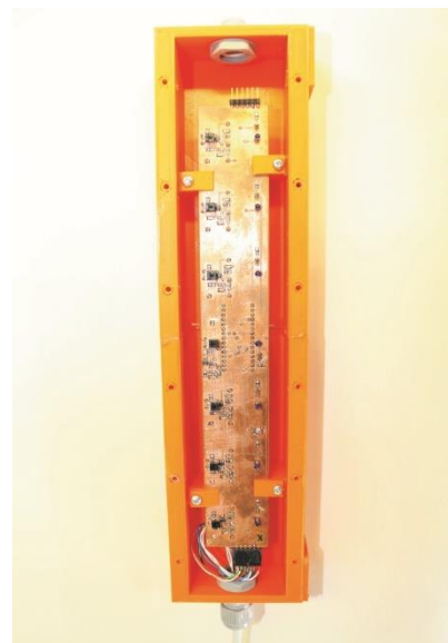
Eines der zwei entwickelten Sensor-Module im Gehäuse mit entfernter Schutzscheibe
