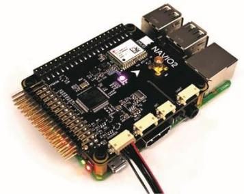
In der Abbildung ist die Plattform, welche für das Projekt benutzt wurde, dargestellt. Sie besteht aus einem Raspberry Pi 3 und einem Navio 2.
