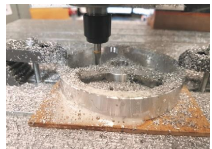
Fräsen eines Schwungrades aus AlMgSi1
