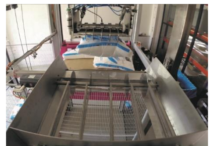
Die Anlage im Betrieb: Ein gegriffener Salzsack wird zu den Trichtern befördert. Im Hintergrund der Hubkorb (pink). Im Vordergrund der Greifer, die Messerwelle sowie der Rüttelmechanismus, welcher die Säcke entleert, und der Trichter.
