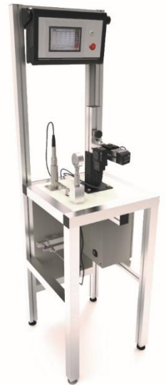
Visualisierung der Manometer- Prüfstation
