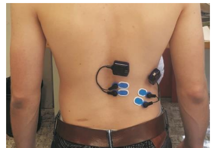
Sensorplatzierung am Rücken für die EMG-Messung
